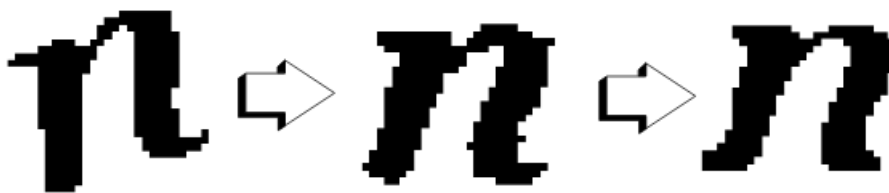
Figura 4 - Exemplo de rotação e preenchimento com buffer, modificam o caractere 'n'
